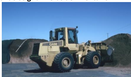
Cargadoras de frente se pueden utilizar para voltear los inventarios de sustrato para macetas.
