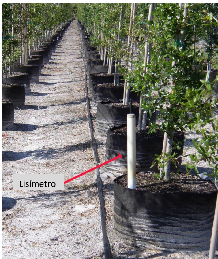
Un Lisímetro de Succión se queda en el contenedor grande para muestreo repetitivo de la solución de contenedor..
